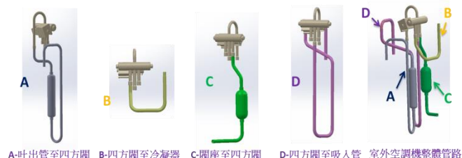
圖 1 室外機管路系統結構圖
