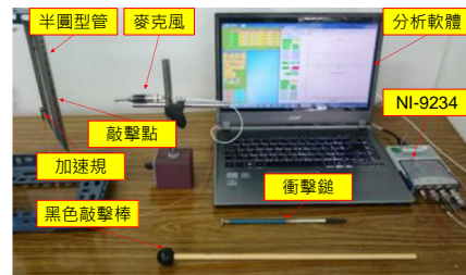
圖 4 半圓型管實驗模態分析與聲音量測實驗儀器架設圖
