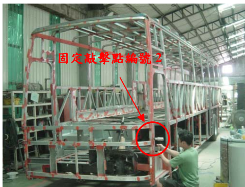
圖 6、整車現場實驗情形
