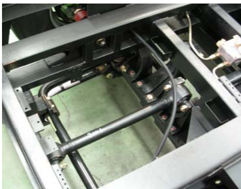
圖 11、前軸與底盤銜接實際照片
