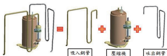
圖 2 壓縮機與管路系統組成示意圖
