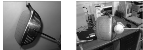
圖 16 (a) 球頭振動量測圖 (b) 球頭衝擊音量測圖
