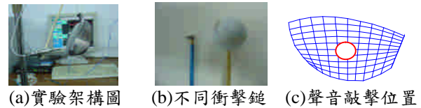
圖3 球頭振動模態與聲音量測架構圖
